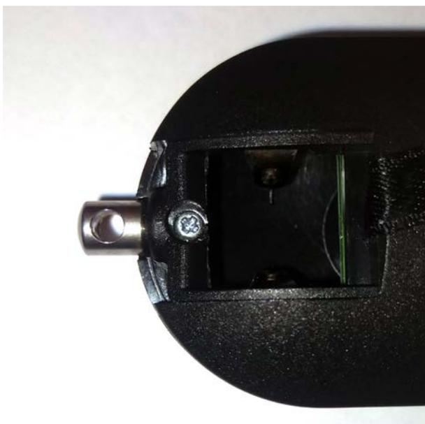
3. Remettez la languette en place et insérez une pile neuve.
