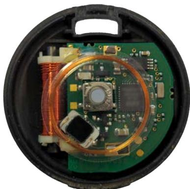
Les transpondeurs peuvent être livrés en option avec différentes puces RFID intégrées. Ces puces RFID n'ont pas nécessairement besoin d'être programmées avec le logiciel LSM. Le transpondeur actif et la pièce RFID passive sont indépendants l'un de l'autre.
