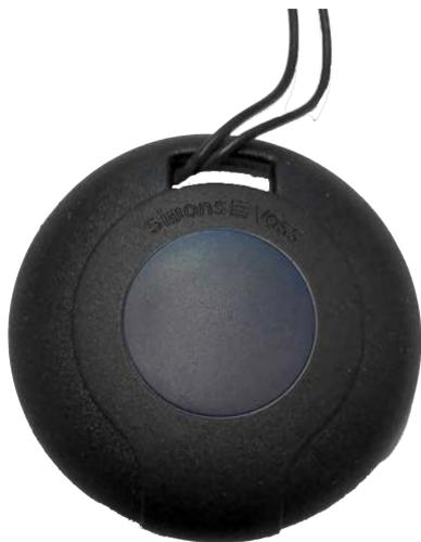
Sur ce transpondeur, les contacts de commande du bouton-poussoir sont reliés à un câble à deux conducteurs (env. 1 m) et orientés vers l'extérieur. Vous pouvez relier les deux fils de ce câble à un contact sans potentiel, par exemple à un relais. Vous actionnez ainsi le transpondeur et pouvez déclencher des actions.
