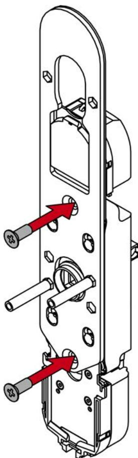
6. Inserire il supporto del modulo con la piastra di fissaggio nel lato esterno della porta.
