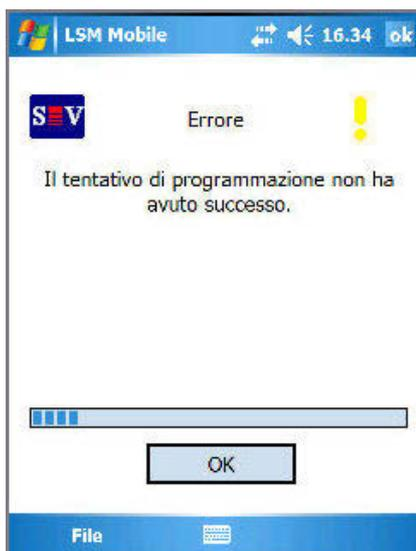
Se, durante una procedura di programmazione, la distanza tra SmartCD e sistema di chiusura digitale è troppo grande o troppo piccola, la programmazione non viene completata.
