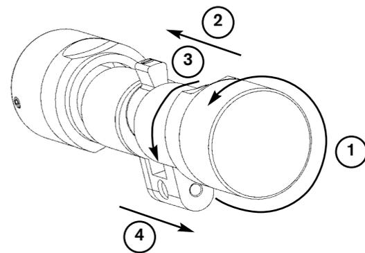
22. Außenseite: Die auf dem Innenrohr befindlichen Metallplättchen entfernen, und ein Kunststoffplättchen auf das Innenrohr schieben (Die benötigten Kunststoffplättchen befinden sich in der Verpackung!).
