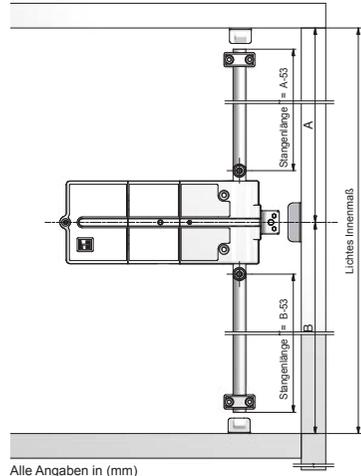
Die Anzeigeeinheit sollte so montiert werden, dass Sie eine gute Sichtverbindung haben. Wenn Sie die Anzeigeeinheit räumlich getrennt von der Steuerelektronik installieren, darf die Länge des Verbindungskabels zwischen diesen Systemkomponenten 1 m nicht überschreiten.
