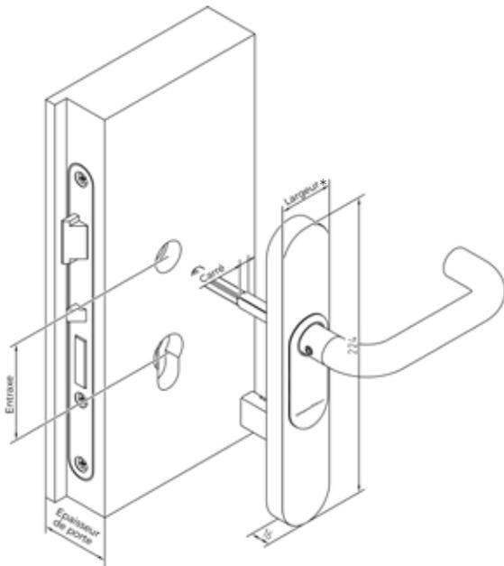
// DIMENSIONS POUR MONTAGE CONVENTIONNEL À FERMETURE MÉCANIQUE
