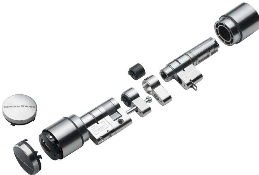
Le Digital Cylinder AX a une structure modulaire. Elle se compose toujours d'un profil de cylindre avec une protection contre le perçage et d'un actionneur intégré dans le rotor, ainsi que d'un bouton extérieur et en option d'un bouton intérieur.
