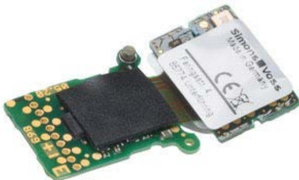
Les piles du Digital Cylinder AX alimentent ensuite également le nœud réseau en énergie. Après l'assemblage, une broche à ressort entre en contact avec le capuchon du bouton de lecture pour communiquer sans fil comme avec une antenne.
