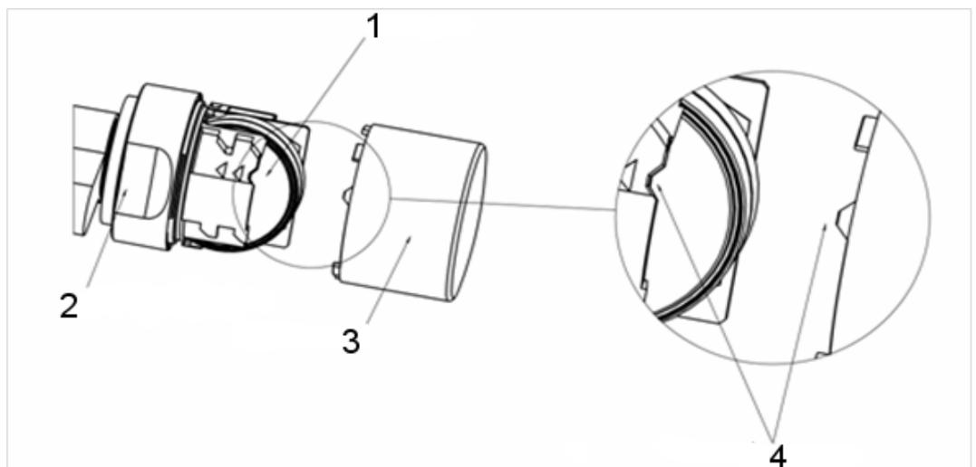
8. Infilare nuovamente il pomolo (secondo le tacche triangolari, vedere schizzo), tenere fermo l'anello dell'impugnatura e fissare il pomolo interno ruotandolo in senso orario (circa 10°)
