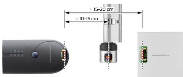
In questo esempio tutte le antenne sono allineate parallelamente l'una all'altra!
