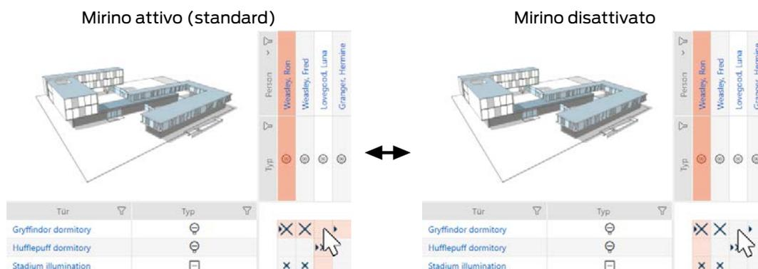
La casella su cui si trova attualmente il puntatore del mouse appartiene a una chiusura o al vostro mezzo di identificazione. Nell'impostazione predefinita, l'intera riga e l'intera colonna sono evidenziate a colori. In questo modo, è possibile trovare rapidamente la chiusura o il mezzo di identificazione corrispondente. Questa funzione si chiama Mirino.
