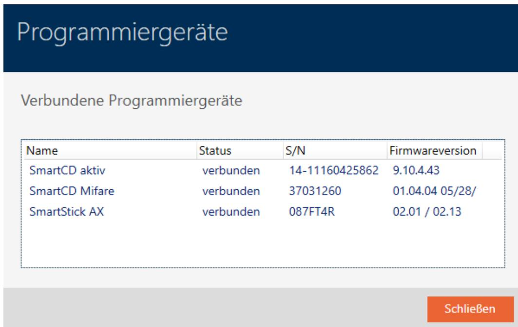
Questa finestra mostra tutti i dispositivi di programmazione supportati. A seconda dell'edizione dell'AXM che usate, sono supportati altri dispositivi di programmazione (vedere Ambito delle funzioni di AXM Lite). Nella colonna Stato potete vedere se un dispositivo di programmazione è collegato e viene riconosciuto da AXM Plus.
