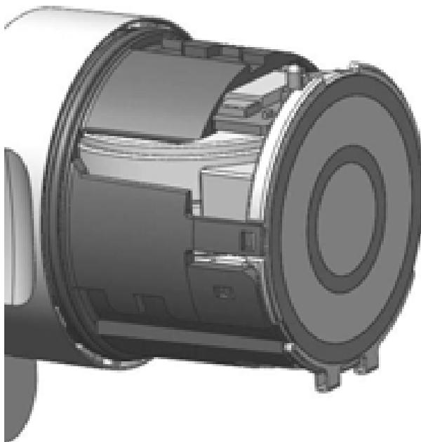
9. Stecken Sie die mitgelieferte Knaufkappe mit der eingeklebten Kontaktfolie auf (Achten Sie auf die Markierungen).
