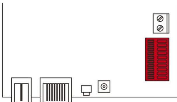
Le connecteur d'E/S vous permet de communiquer avec des appareils externes. Appuyez sur la borne à ressort avec un tournevis pour raccorder ou retirer le câble. Pour plus de détails et pour consulter des exemples de câblage du connecteur d'E/S, consultez le manuel RouterNode-2.
