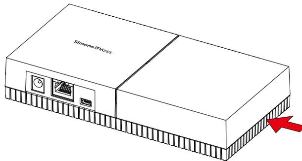
2. Vérifiez que l'ouverture du boîtier présente la largeur nécessaire. La hauteur de l'ouverture s'élève à env. 7 mm. Chaque barre retirée élargit l'ouverture de 4 mm.
