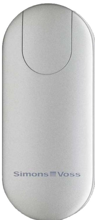
Mit dem CompactReader machen Sie aus Ihren aktiven Schließungen im Handumdrehen hybride Schließungen, die auch passive RFID-Identmedien, z.B. eine Karte, lesen können. Der CompactReader wird beim Programmieren fest an die Schließung gekoppelt. Er liest die Karte aus und leitet die Daten an die Schließung weiter.
