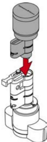
12. Replacez le clip avec l'ergot en direction de la vis de maintien dans la fente du cylindre profilé.
