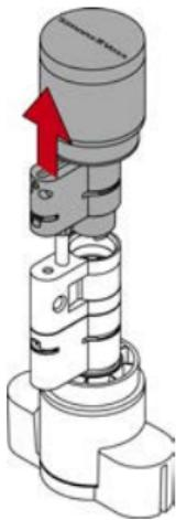
↳ Erste Zylinderhälfte ohne Mittelstück vorbereitet.
