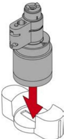
9. Setzen Sie das Halbzylinder-Mittelstück auf die vorbereitete Zylinderhälfte.
