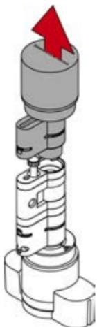
6. Schrauben Sie mit dem Ausheber den Bolzen heraus.
