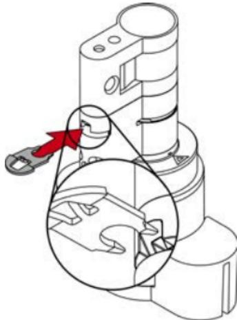
13. Placez le cylindre dans le bloc de serrage de manière à ce que le cylindre profilé et le bouton afferentent dans les évidements.
