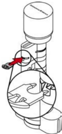
15. Placez le cylindre dans le bloc de serrage de manière à ce que le cylindre profilé et le bouton afferentent dans les évidements.
