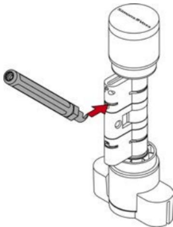
8. Hebeln Sie die Klammer aus dem Profilzylinder, indem Sie den Ausheber in die Mitte des Zylinders bewegen.
