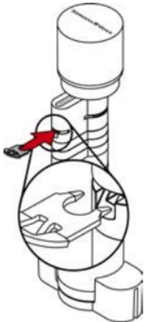
15. Placez le cylindre dans le bloc de serrage de manière à ce que le cylindre profilé et le bouton afferluent dans les évidements.
