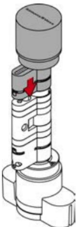
14. Replacez le clip avec l'ergot en direction de la vis de maintien dans la fente du cylindre profilé et appuyez fermement sur le clip avec le pouce pour qu'il ne puisse plus tomber.
