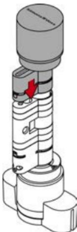
14. Setzen Sie die Klammer mit der Nase zur Stulpschraube wieder in den Schlitz des Profilzylinders ein und drücken Sie die Klammer mit dem Daumen fest, damit sie nicht mehr herausfallen kann.
