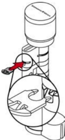
13. Placez le cylindre dans le bloc de serrage de manière à ce que le cylindre profilé et le bouton afferluent dans les évidements.
