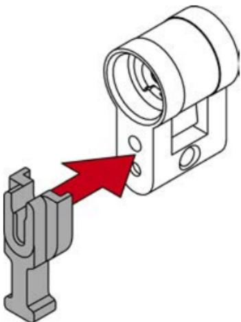
7. Schrauben Sie mit dem Ausheber einen passenden Verlängerungsbolzen ein, bis er am Abstandshalter anliegt.
