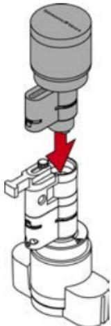
12. Setzen Sie die Klammer mit der Nase zur Stulpschraube wieder in den Schlitz des Profilzylinders ein.
