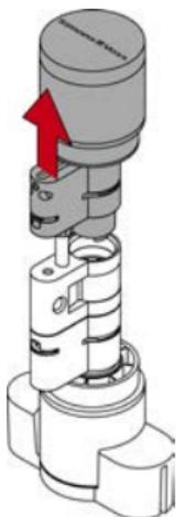
↳ Zweite Zylinderhälfte ohne Mittelstück vorbereitet.
