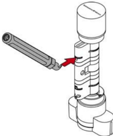
3. Hebeln Sie die Klammer aus dem Profilzylinder, indem Sie den Ausheber in die Mitte des Zylinders bewegen.
