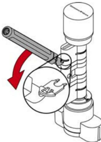
4. Ziehen Sie die Klammer vollständig aus dem Profilzylinder.
