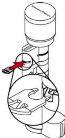
13. Setzen Sie den Zylinder in den Klemmblock ein, so dass der Profilzylinder und der Knauf bündig in den Aussparungen liegen.
