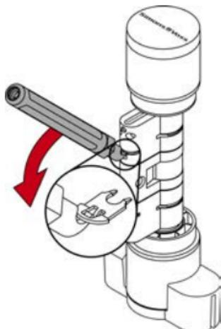
9. Ziehen Sie die Klammer vollständig aus dem Profilzylinder.
