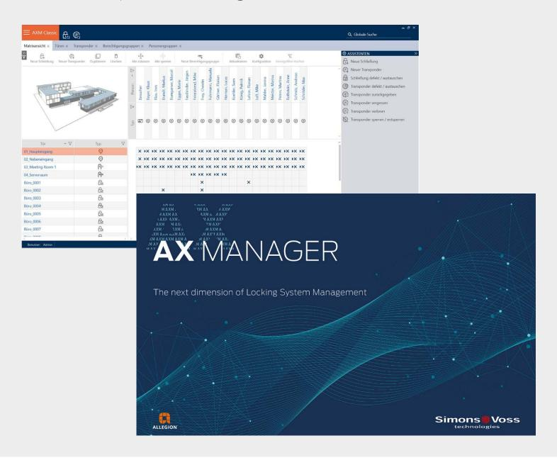
AX Manager (AXM) sostituisce il software Locking System Management (LSM). Con l'edizione AXM Classic è possibile gestire nel sistema 3060 fino a 64.000 chiusure e mezzi di identificazione per ogni impianto. Questa versione supporta, inoltre, sia la tecnologia a transponder attivi di SimonsVoss, sia i
