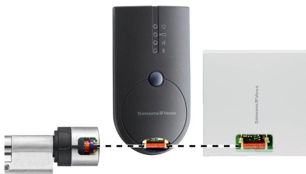
In questo esempio, tutte le antenne sono orientate parallelamente!
