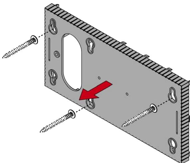
6. Spostate la piastra di base in modo che le teste delle viti vengano spinte sopra le scanalature.
