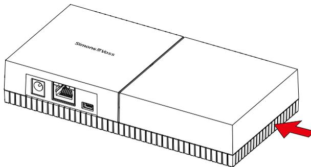
2. Verificate che l'apertura della cassa sia dell'ampiezza necessaria. L'altezza dell'apertura è di ca. 7 mm. L'apertura si allarga di 4 mm a ogni listello rimosso.
